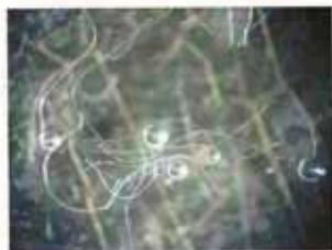
Cantitate redusă de spumă stabilă formată la suprafața probei la efectuarea testului pentru materiale grase cu  $\text{NH}_3$  25% și  $\text{H}_2\text{O}_2$  30%
